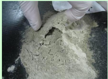
ダストシャット添加時、土砂表面に皮膜ができる、土砂が飛散しない
