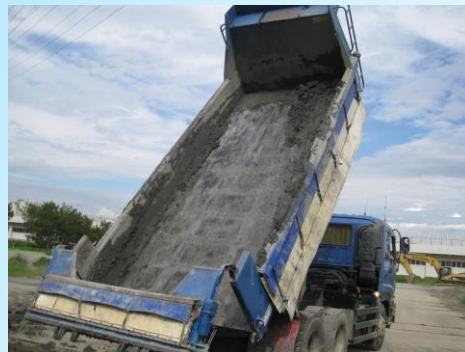
土砂荷降ろし後 土砂の付着無し
