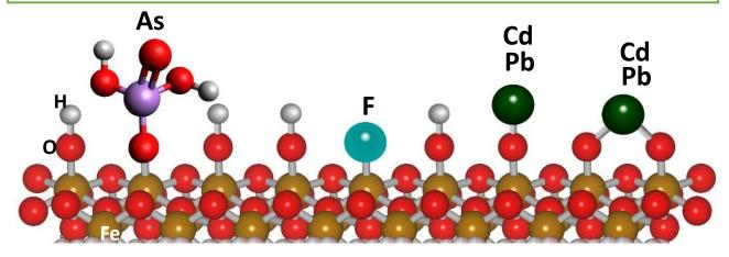
また、フッ素(F-)は、トンネル内部に保持された塩化物イオン( $C\Gamma$ )との交換反応によっても取り込まれます。
