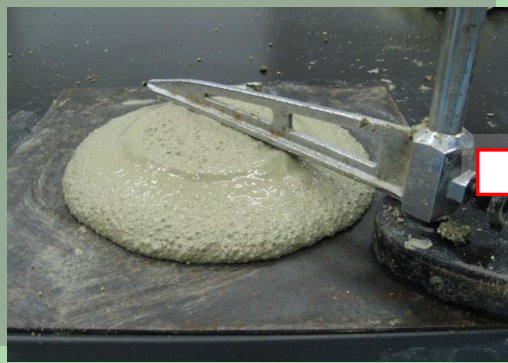
Before adding TG Rock-P Mini slump value: 10 cm
