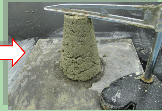
After adding TG Rock-P 1.5 kg/m 3 Mini slump value: 0 cm
