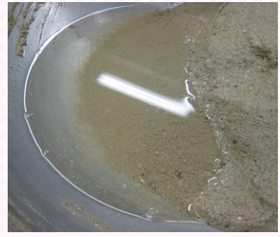
TG オイルロック + 生石灰投入後土壌 (油微粒子を吸着)
