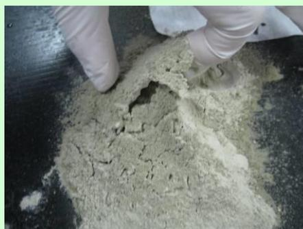
ダストシャット添加時、土砂表面に皮膜ができ、土砂が飛散しない
