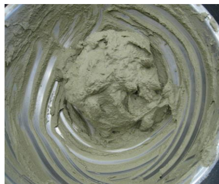
TG パリック II + TG ジェル併用使用 極度に泥水化することなく 良質の排出土に改良できる
